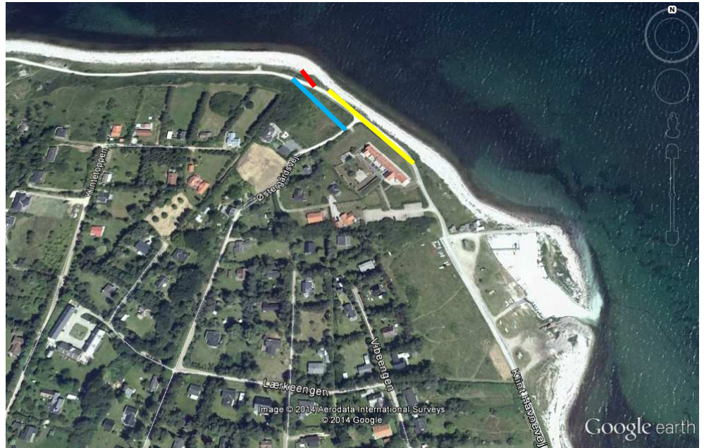
Figur 6-10 Omlægning af vej Blå: Ny vej som anlægges på privat grund, som delvist eksproprieres Rød: Stenbeskyttelse ved højdedrag Gul: Eksisterende grusvej droppes
